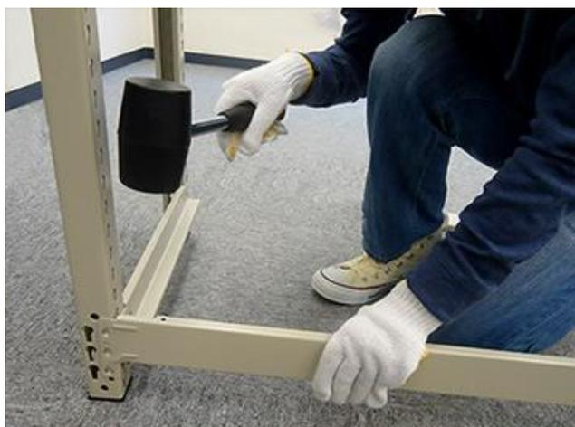
ワイドビームの左右両端のツメをそれぞれ支柱最上段・最下段のプレス穴にあてて、ハンマーで叩き込んでください。（左右ともに）
